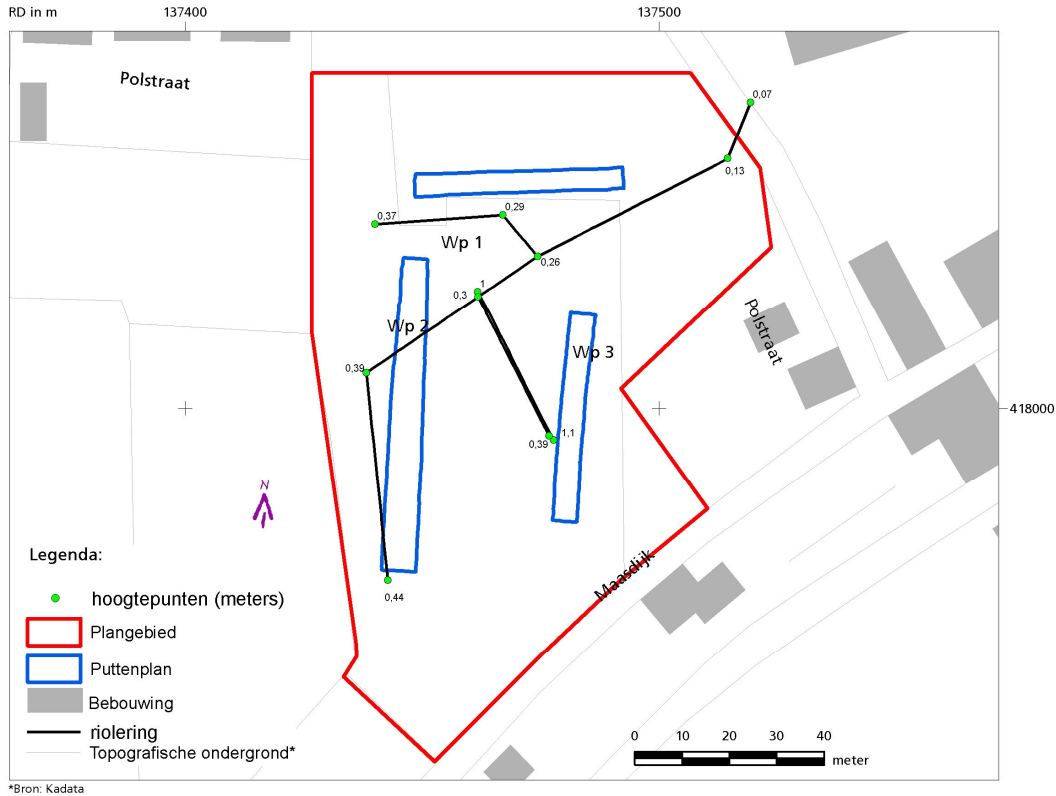
Fig. 8: De toekomstige riolering ingetekend ten opzichte van de proefsleuven. De hoogtes in NAP betreffende onderkant van de riool.
