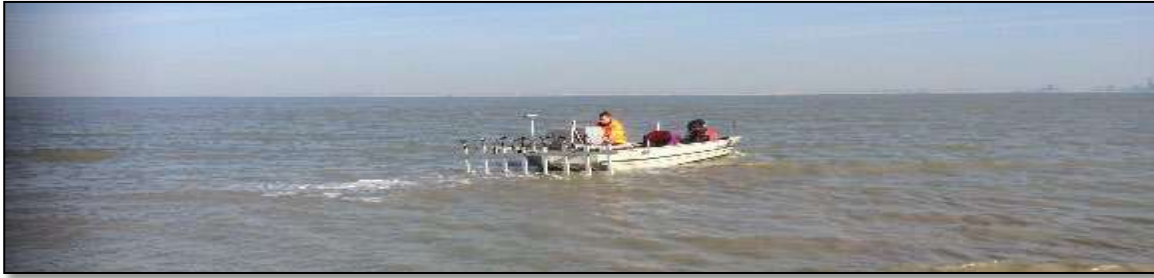
Uitvoeren passieve NON realtime waterbodemdetectie m.b.v. detectieboot.
