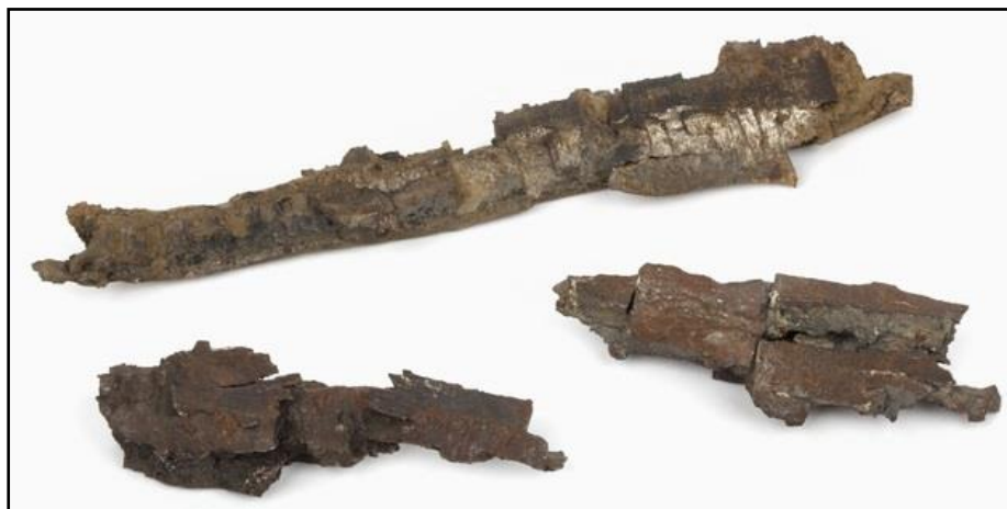
Figuur 20. Scherven afkomstig van een projectiel dat was gevuld met springstof, na detonatie.
