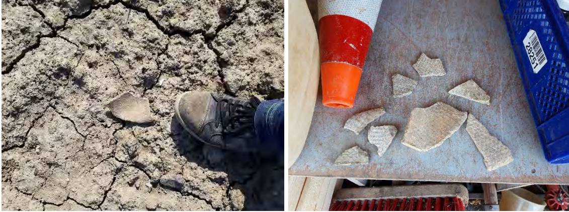
Figuur 2.3: Asbestverdacht plaatmateriaal op maaiveld tijdens terreinverkenning op 27 maart 2020
