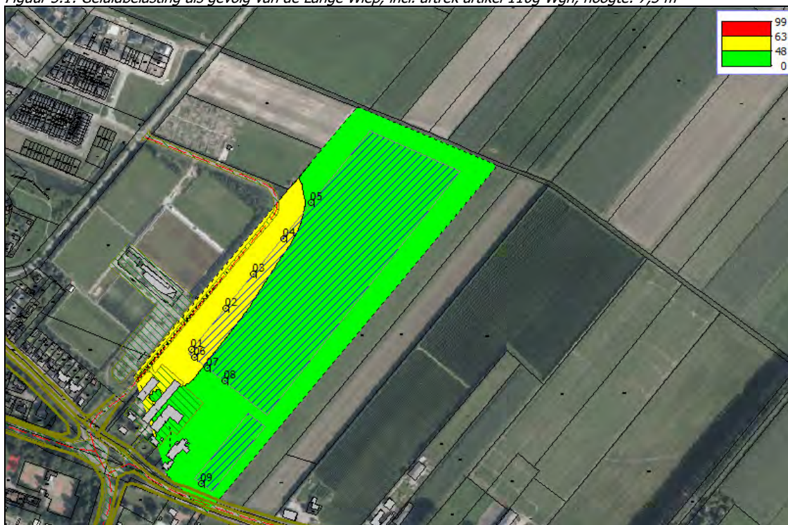
Figuur 5.1: Geluidbelasting als gevolg van de Lange Wiep, incl. aftrek artikel 110g Wgh, hoogte: 7,5 m
