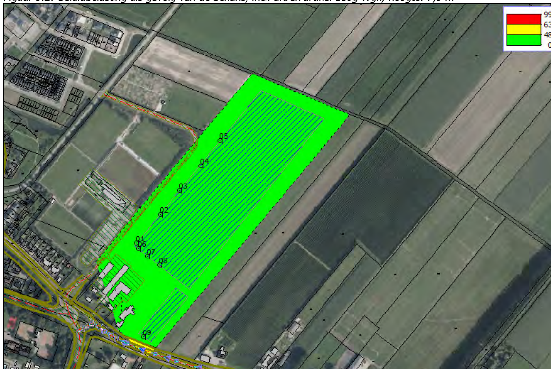
Figuur 5.2: Geluidbelasting als gevolg van de Schans, incl. aftrek artikel 110g Wgh, hoogte: 7,5 m
