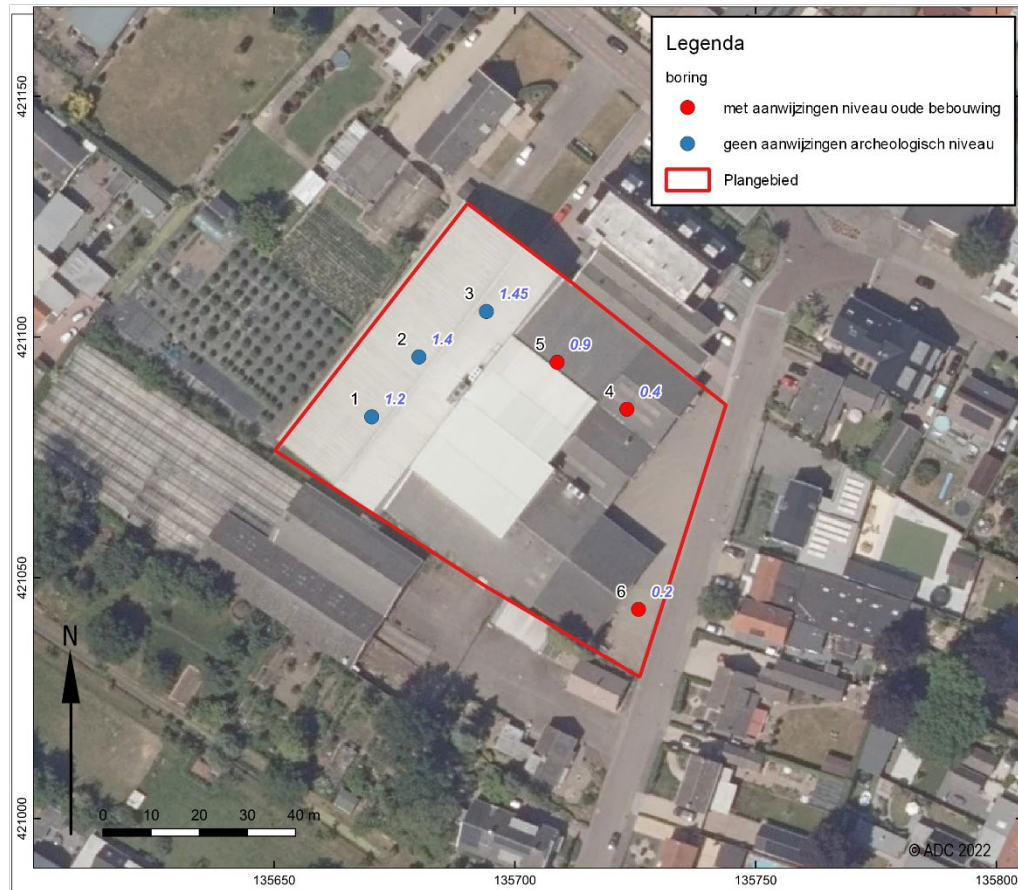
Afb. 15 Resultaten booronderzoek met in blauw de top van het niveau van de oude bebouwing cq. de top van ongestoorde afzettingen.
