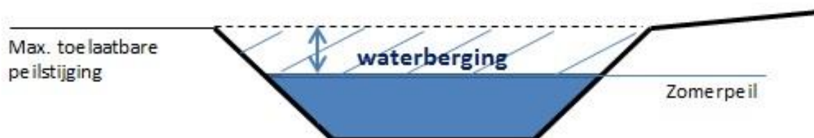
Figuur 3.1 Voorbeeld waterberging in oppervlaktewater
