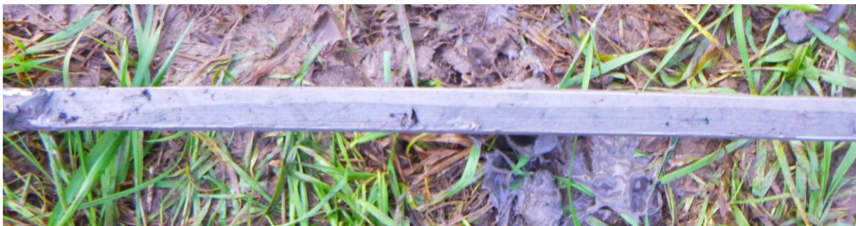
Figuur 20: Foto van de matig venige klei (rechts) zoals deze in boring 3 boven de zwak venige klei (links), is aangetroffen.
