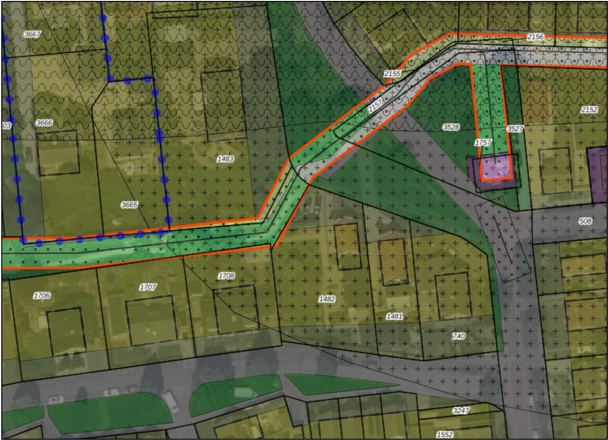
Locatie rioolpersleiding met beschermingszone
