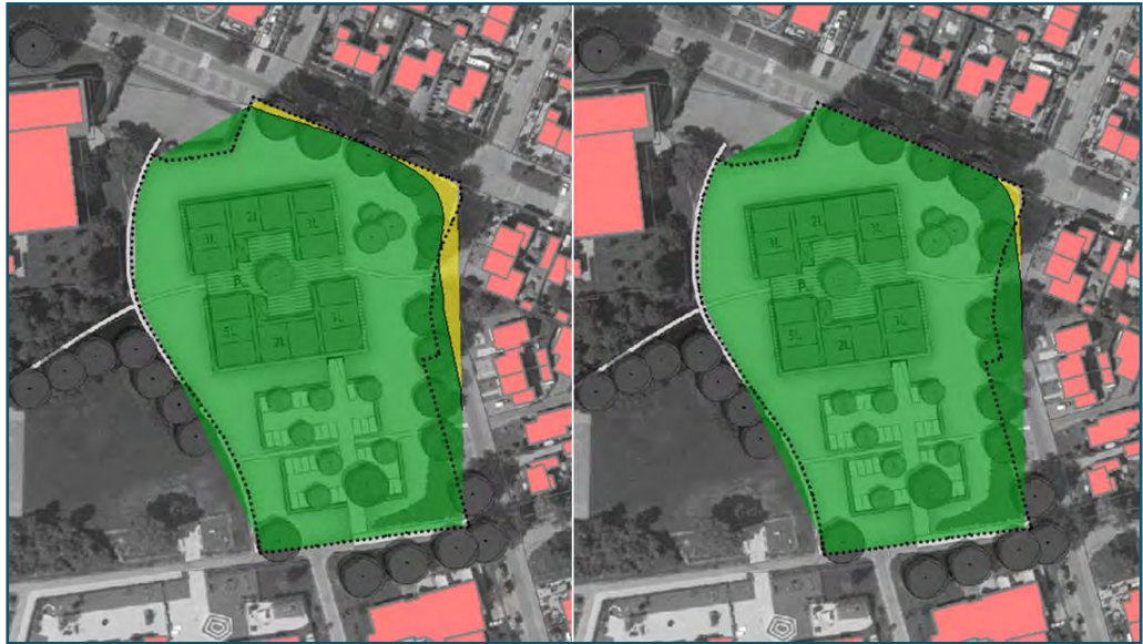
Figuur 5 Geluidsbelasting vanwege alle wegen samen op 10,5 en 13,5 meter beoordelingshoogte.
