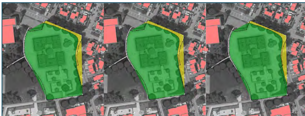
Figuur 4 Geluidsbelasting vanwege alle wegen samen op 1,5, 4,5 en 7,5 meter beoordelingshoogte.
