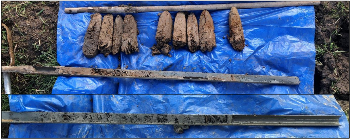
Boring 7: 0-270 cm -Mv, dieper gelegen (bedding)zand loopt uit de boor door de ligging beneden het grondwaterpeil.
