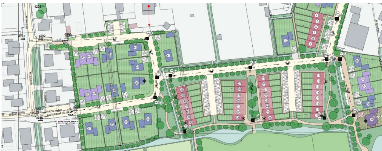
Figuur 4-12: uitsnede uit schetsontwerp DWA riool
