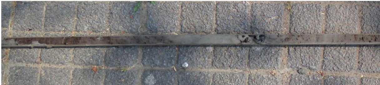
Figuur 19: Foto van boring 4 met de venige klei zoals deze onderin de boringen 4 en 5 is aangetroffen.
