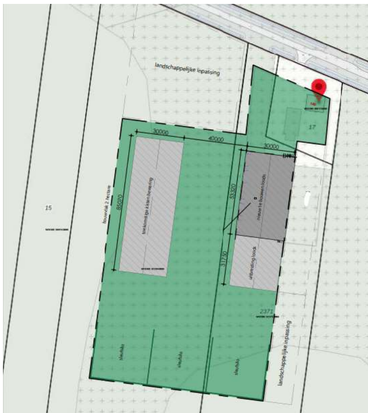
Figuur 4: gewenste vorm bouwvlak met contouren bouwplan
