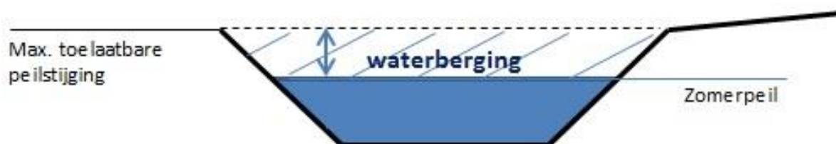
Figuur 3.1 Voorbeeld waterberging in oppervlaktewater
