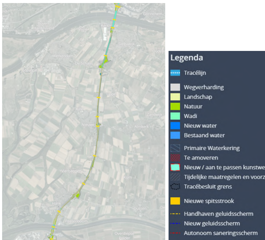
Figuur 6.3 Ontwerptekening verbreding A27 (bron: Rijkswaterstaat)
