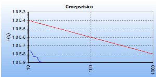
Figuur 15 FN-curve van de kilometer met de hoogste overschrijdingsfactor van gastransportleiding Z-543-03 in de toekomstige situatie. De ligging van deze kilometer is hiernaast in het rood weergegeven op een topografische kaart.
