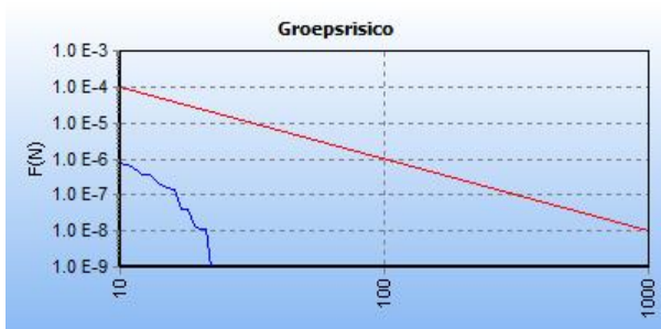
Figuur 9 FN-curve van de kilometer met de hoogste overschrijdingsfactor van gastransportleiding Z-543-01 in de huidige situatie. De ligging van deze kilometer is hiernaast in het rood weergegeven op een topografische kaart.
