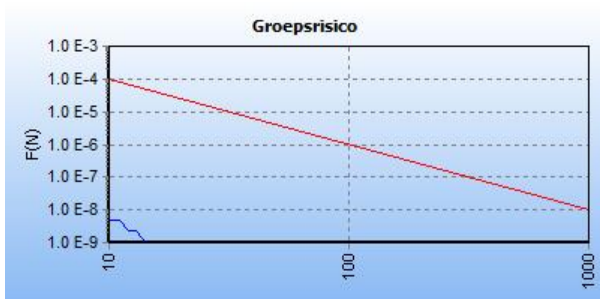
Figuur 13 FN-curve van de kilometer met de hoogste overschrijdingsfactor van gastransportleiding Z-543-03 in de huidige situatie. De ligging van deze kilometer is hiernaast in het rood weergegeven op een topografische kaart.
