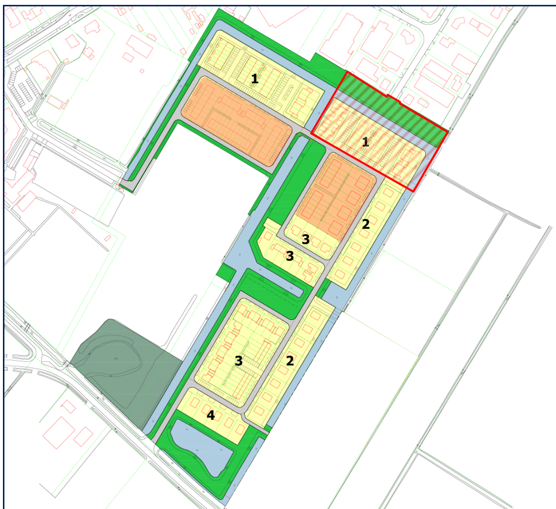
Indicatieve verkaveling met gerealiseerde wooneilanden in oranje (rood gearceerde gedeelte is buiten dit bestemmingsplan gehouden)
