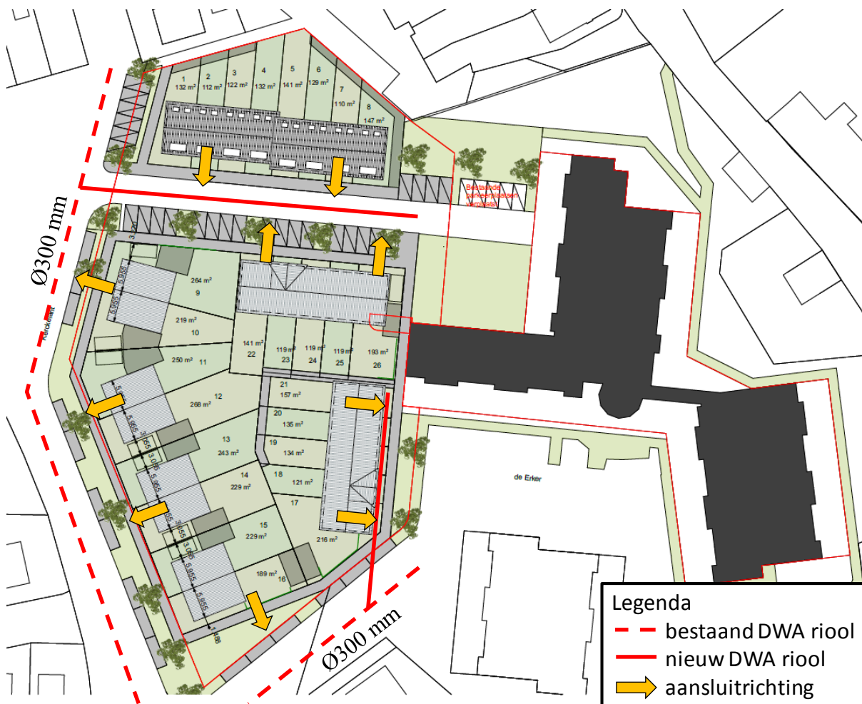
figuur 4 Schematisch ontwerp DWA systeem
