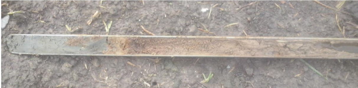
Figuur 18: Foto van boring 1 met de overgang van het pakket geoxideerd zand met het onderliggende, door zandlaagjes onderbroken kleipakket..
