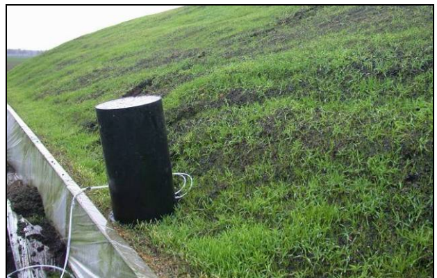
Meting sleufsilos met omgekeerd vat op de maïshoop
