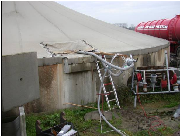
Meting mestsilo, ventilator met injectie en monsternameleidingen
