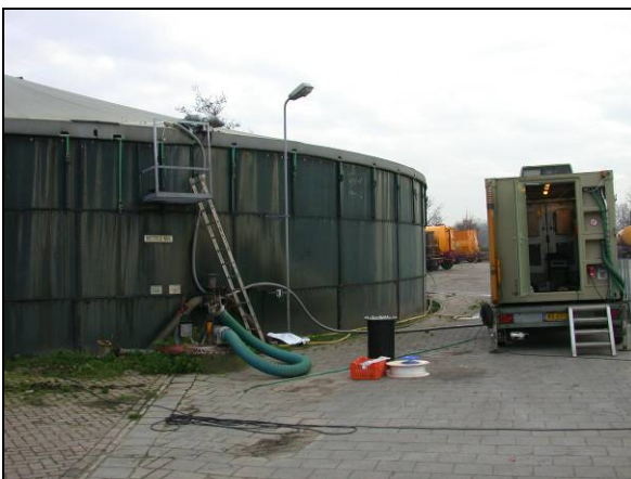
Meting mestsilo met interne tracergas ratiomethode
