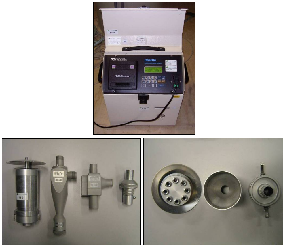
Figuur 4 Monsterrapparaat voor PM10 en PM2,5. Linksboven: de 'constant flow' monsternamepomp. Rechtsboven: De DustTrak model 8520 voor optische en continue metingen van het verloop in PM10 concentratie. Linksonder (van links naar rechts): inlaat, PM10 cycloon, PM2,5 cycloon en filterhouder. Rechtsonder (van links naar rechts): de constructie van de inlaat
