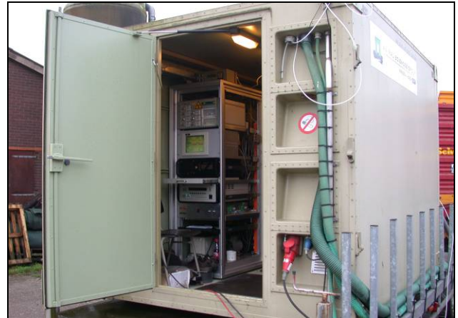
Meetshelter met injectieapparatuur, GC voor bepaling SF 6 -concentratie en multigasmonitor voor bepaling broeikasgassen en NH 3 .
