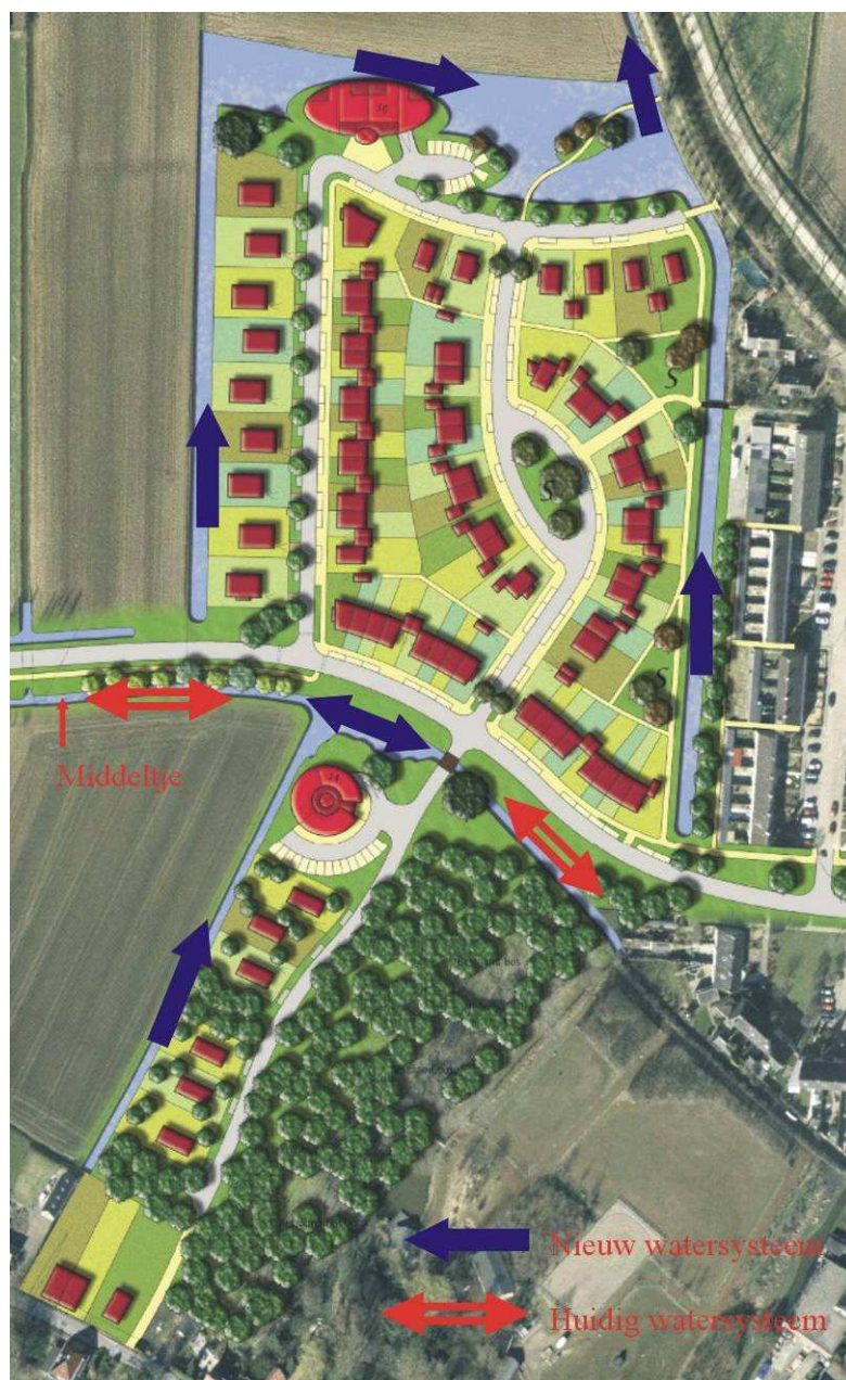
Afbeelding 18 Principeschets van het watersysteem.
